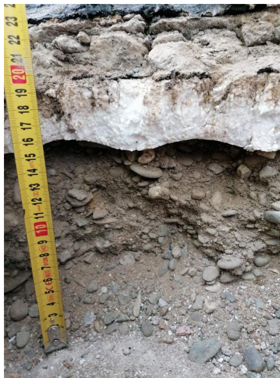
Obrázek 1: Fotografie sondy S1 do střešního pláště objektu kotelny – vrchní část skladby
